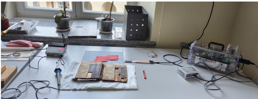
8 PAV. Didžiausio iškritusio vaško fragmento įklijavimas naudojant aparatus „Waxlectric I“ ir IMAT
