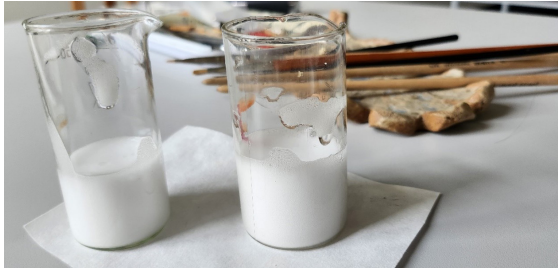
5 PAV. 1 % Klucel G tirpalo putos, skirtos medžio ir vaško dalims valyti
